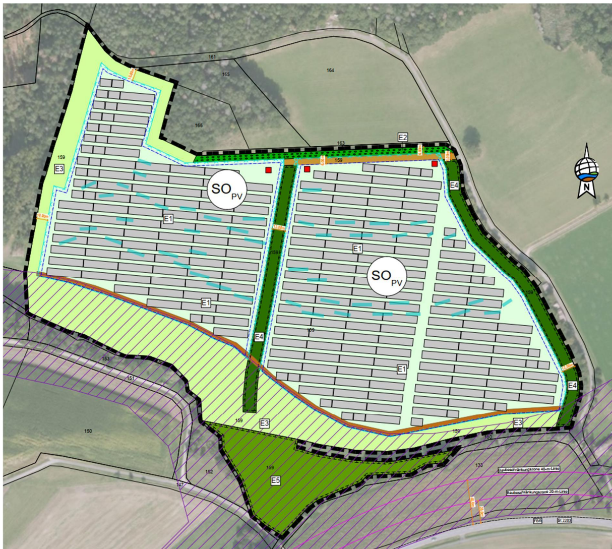
Ausschnitt des Bebauungsplanes zur Anlage der Mulden (türkis) und des Walles (braun), wassersensibler Bereich (lila schraffiert)
